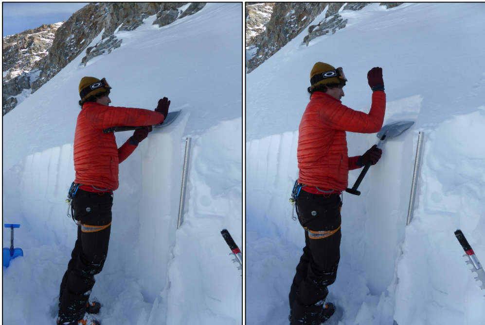
Mesure de test en compression. La Grave, Glacier du Vallon. Mars 2015
